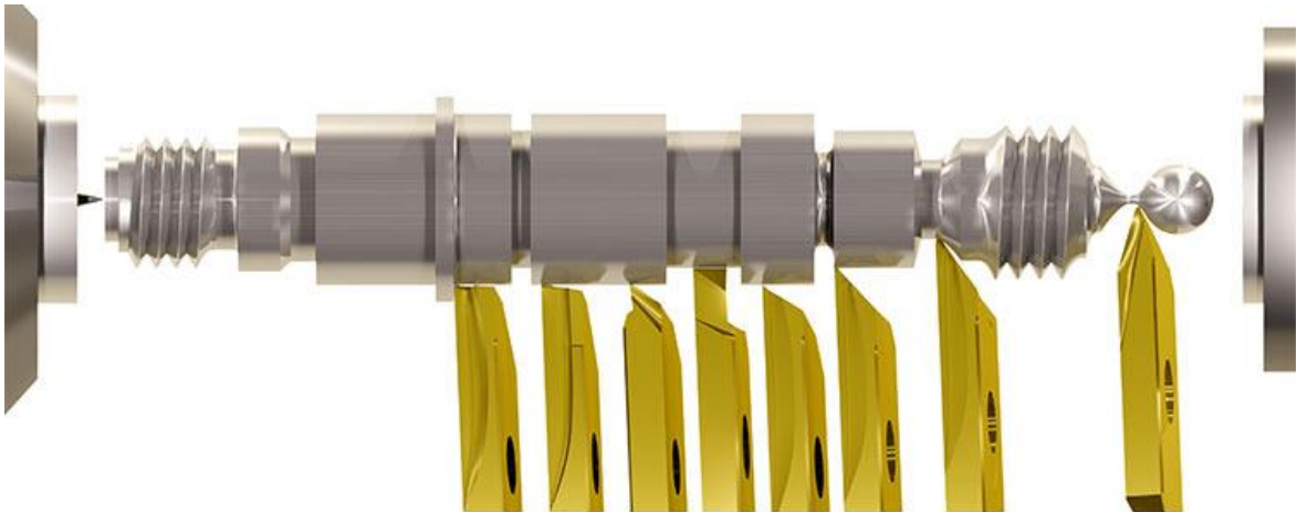
شكل رقم ٤١: أنواع أقلام القطع الخارجية من النوع J-type
